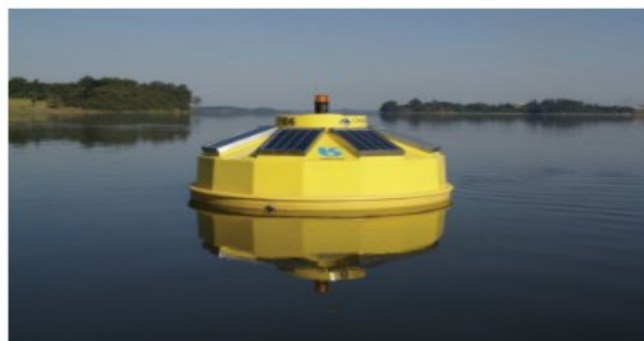
Figura 8 - Exemplos de Sondas em Bóias com Sensores para Monitoramento da Qualidade da Água em Tempo Real
