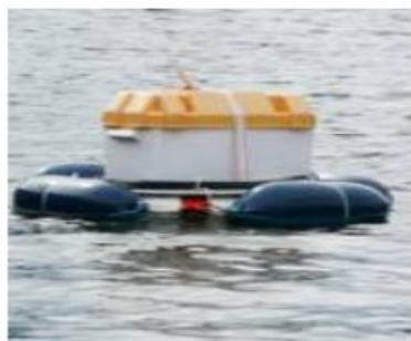
Figura 8 - Exemplos de Sondas em Bóias com Sensores para Monitoramento da Qualidade da Água em Tempo Real
